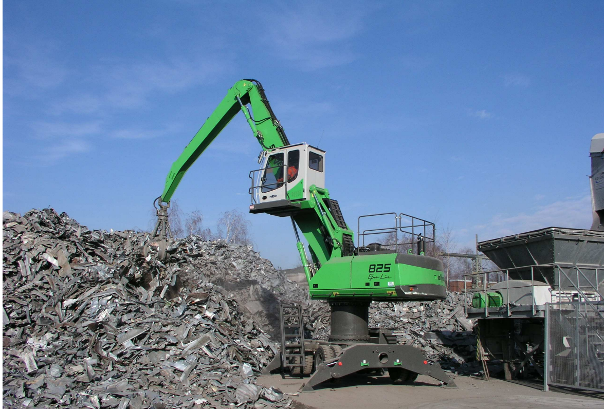
Aufgabe des unsortierten Schrottes in den Zerkleinerungstrichter
